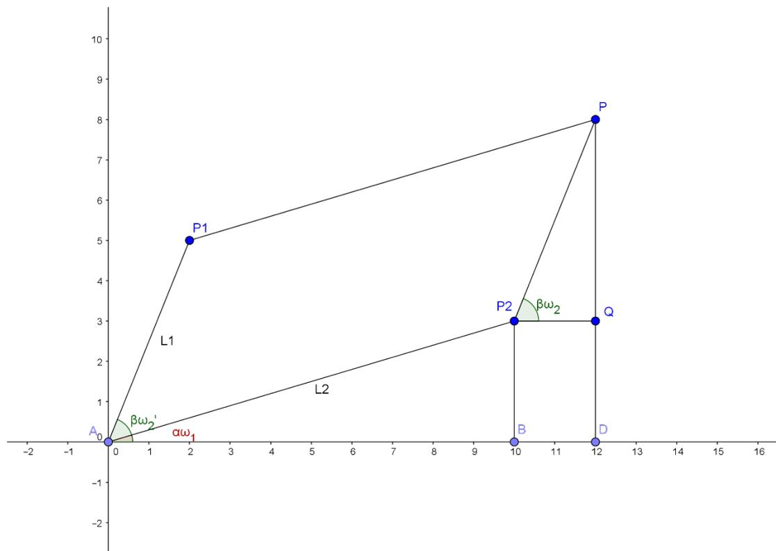
Um dies nachzuprüfen stellen wir folgende Überlegungen an. Zunächst legen wir eine Startposition fest, sodass alle Punkte des Parallelogramms auf der x-Achse liegen. Wir führen auch noch eine Variable  $t$  für die vergangene Zeit ein. Folglich ist  $OP_1$  nach gewisser Zeit  $t$  um  $t\omega_1$  und  $OP_2$  um  $t\omega_2$  gegen den Uhrzeigersinn gedreht.
