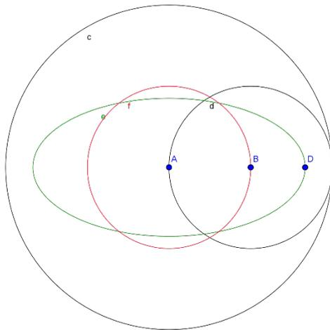
Man nimmt einen Innenverzahnten festen Kreis c und einen außenverzahnten beweglichen Kreis d mit halbem Durchmesser. Man wählt auf dem beweglichen Kreis einen Fixpunkt D, der z. B. eine elliptische Spur hinterlässt. Anschließend wählt man einen zweiten
